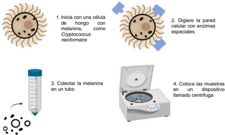
Figura 4. Esquema para el aislamiento de melanina a partir de biomasa fúngica. Figura creada en biorender.com. Las enzimas digestivas se representan como recuadros azules.
